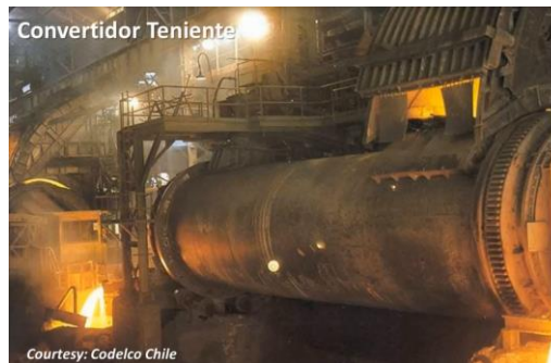
Fig.1 テニエンテ式溶解炉
